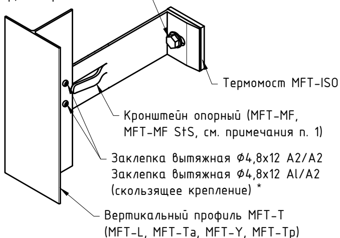
Узел №3 (увеличено, вариант с кронштейном MFT-MF H)
